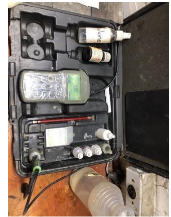
Figura 10: Calibración de los pH-metros de pelambre y la PTAR.
