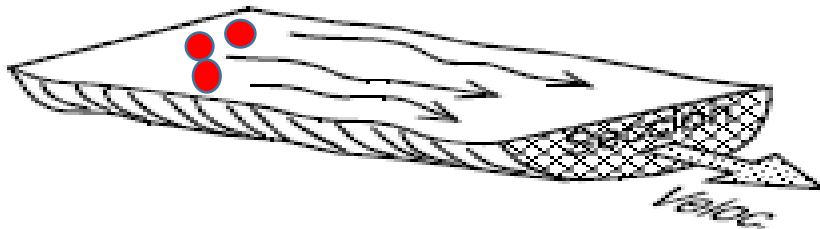
Figura 1. Medición de caudal método de flotador
