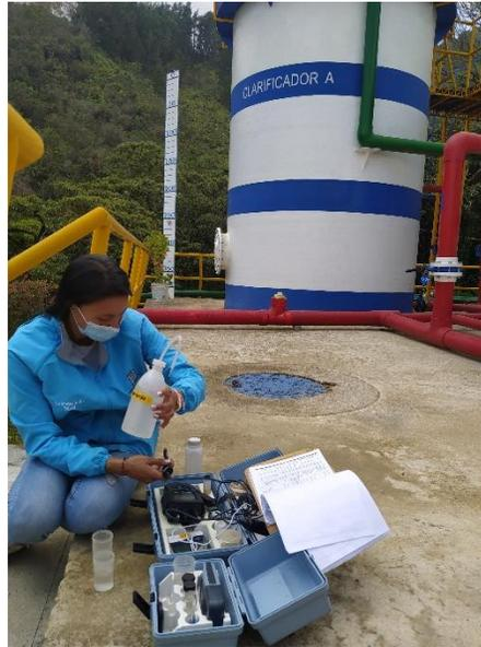
**Imagen 9.** Toma de muestra de pH, Oxígeno disuelto, temperatura y Cloro libre con los equipos DR300 Clorine y HQ40d multi.
