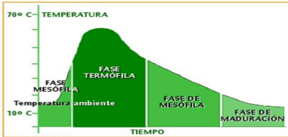
Ilustración 3. Etapas del proceso de compostaje
