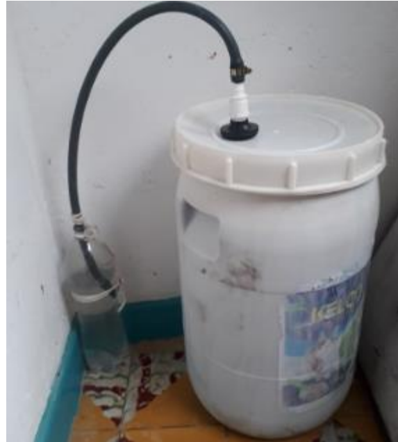
Ilustración 8 Prueba piloto, biol preparado y en reposo para fermentación, fuente propia.
