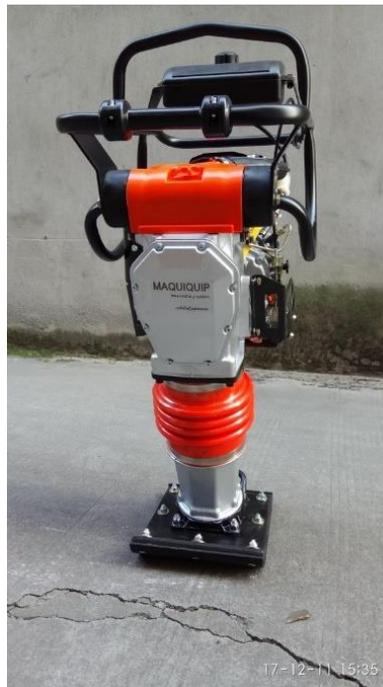
Figura 9: compactador tipo canguro. fuente: ECOMEC S.A.
